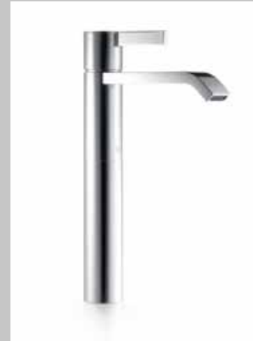
33 537 670 Single-lever basin mixer without pop-up waste, 165 mm projection // Miscelatore monocomando lavabo senza piletta, sporgenza 165 mm // Monomando de lavabo sin válvula automática, saliente 165 mm [8,3 l/min. / 2.2 gpm]
